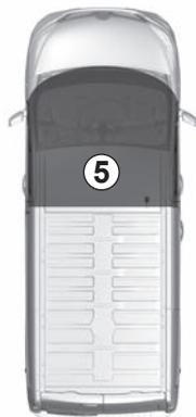
Con el motor en marcha, si tras haber abierto o cerrado una puerta, la tarjeta ya no se encuentra en la zona **5**, el mensaje «TARJETA NO DETECTADA» (acompañado de una señal acústica, cuando la velocidad supera un umbral) le avisa de que la tarjeta ya no se encuentra en el vehículo. Esto evita, por ejemplo, reanudar la marcha si un pasajero abandona el vehículo llevándose la tarjeta.
