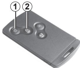
Cuando el vehículo va equipado con la supercondenación, ésta permite bloquear los abrientes e impedir así la apertura de las puertas por las empuñaduras interiores (caso, por ejemplo, de una rotura del cristal seguida de un intento de abrir las puertas por el interior).
