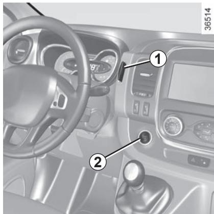
La tarjeta **RENAULT** debe estar en el lector de tarjeta **1** o en la zona de detección **3**.
