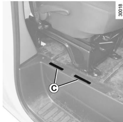
Para acceder al tipo de homologación del vehículo y al número dentro de la serie del tipo, suelte las tapas **C** con una herramienta del tipo destornillador plano.
