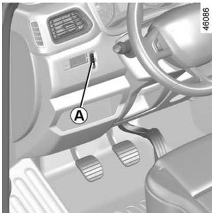
Para los vehículos que se encuentren equipados, el mando **A** permite corregir la altura de los faros en función de la carga.
