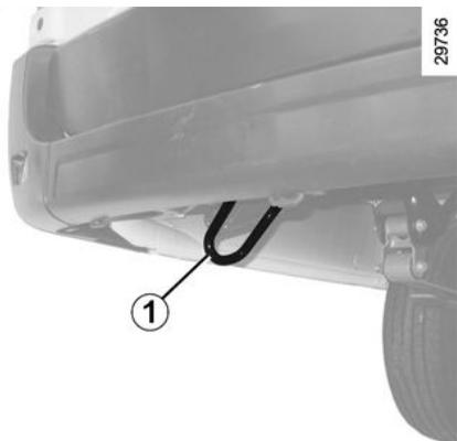
Estos puntos de remolcado tan solo se pueden emplear para remolcar, en ningún caso deben servir para levantar directa o indirectamente el vehículo.
