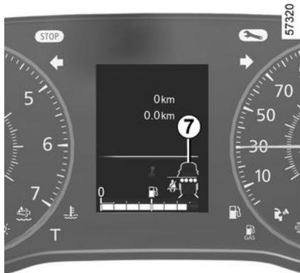
El testigo **7** se muestra en el cuadro de instrumentos al poner el contacto. Esto informa al conductor del estado de sujeción de los cinturones de seguridad traseros cada vez:
