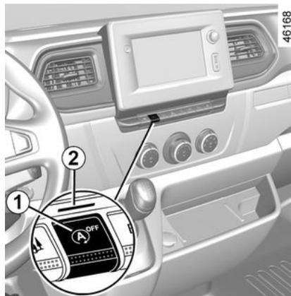
Pulse el interruptor **1** para desactivar la función. El testigo **2** se ilumina.
