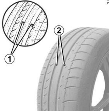
Los neumáticos deben estar en buen estado y sus dibujos deben presentar una profundidad suficiente; los neumáticos homologados por nuestros servicios técnicos van provistos de testigos de desgaste **1** compuestos por **indicadores en varios puntos de la banda de rodadura**.
