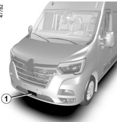
Utilizando la información procedente del radar **1**, el sistema calcula la distancia que le separa del vehículo situado delante.
