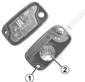
Abra la caja por la hendidura **1** con un destornillador plano o una herramienta similar y sustituya la pila **2** respetando el modelo y la polaridad que se muestran en el fondo de la tapa.
