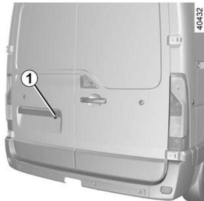
Al meter la marcha atrás, la cámara **1** situada en el portón trasero o, según el vehículo, en la puerta trasera batiente, transmite una visión de la zona posterior del vehículo al espejo retrovisor **2** o, según el vehículo, a la pantalla multimedia **3**, junto con dos líneas auxiliares móviles o fijas **4** y **5**.
