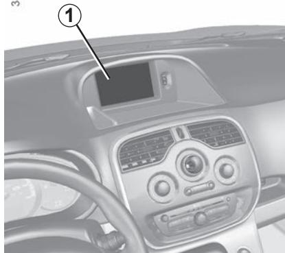
**Nota:** según el vehículo, la pantalla **1** permite visualizar el entorno del vehículo como complemento de las señales acústicas.
