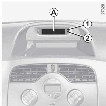
Con el contacto puesto, la hora, y según el vehículo, la temperatura exterior se visualizan.
