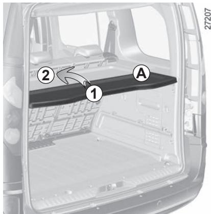
El cubreequipajes está compuesto de dos partes rígidas.
