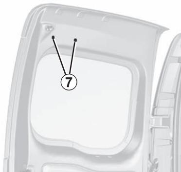
Desde el interior, retire los dos obturadores de plástico 7. Suelte el piloto con un destornillador, presionando en el alojamiento de las grapas metálicas.
