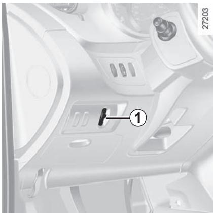
La moleta **1** permite corregir la altura de los faros en función de la carga.
