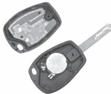
**Nota:** al sustituir la pila, se aconseja no tocar el circuito electrónico situado en la tapa de la llave.
