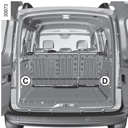
En función del vehículo, en caso de un pinchazo, utilice el kit situado en la guantera o en el maletero, en el arco de rueda trasero **C** o **D**.
