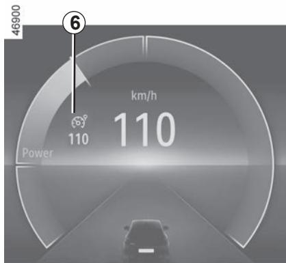
Para guardar la velocidad actual, pulse los botones **4** (RES/+) o **3** (SET/-): la velocidad limitada reemplaza los guiones y, según el vehículo, el testigo **6** aparece en blanco.
