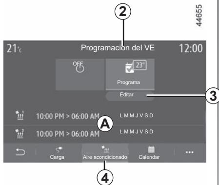
En vehículos equipados con un sistema de climatización automática, puede ajustar la temperatura **5** desde este menú y activar/desactivar los programas memorizados. Seleccione la fecha y la hora **6** del programa que desee modificar para acceder a los ajustes.
