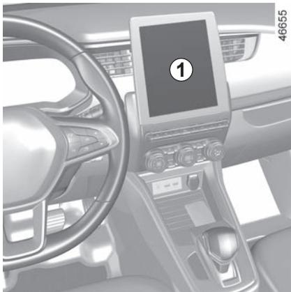
Con el motor en marcha y el vehículo parado, en la pantalla multimedia **1** seleccione el menú «Ajustes» y la pestaña «Vehículo» y, a continuación, seleccione el menú «Programación del VE» **2** y la pestaña «Aire acondicionado» **4**.
