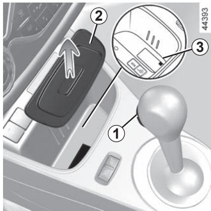
Si la palanca se queda bloqueada en **P** a pesar de estar pisando el pedal de freno y pulsando el botón de desbloqueo **1**, es posible liberar manualmente la palanca. Para ello, retire la moqueta **2** en la parte inferior del compartimento para acceder a la palanca **3**. A continuación, levante la palanca **3** y pulse simultáneamente el botón de desbloqueo **1** situado en la palanca. Consulte lo antes posible a un Representante de la marca.
