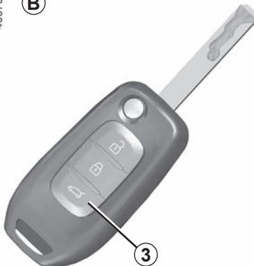
**Nota:** con el motor en marcha o con el contacto puesto (en la posición accesorios), los botones de la llave están inactivos.
