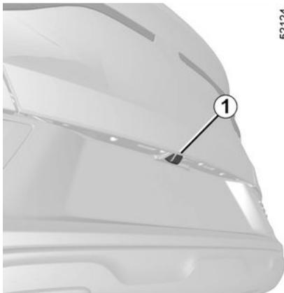
Al meter la marcha atrás, la cámara **1** situada en la tapa del maletero transmite una vista del entorno trasero del vehículo en la pantalla
