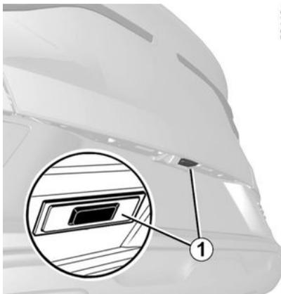
Pulse el botón **1** para abrir la puerta del maletero unos centímetros. Levante la puerta del maletero.
