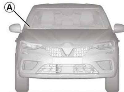
El código QR de la etiqueta A permite a los trabajadores de emergencia provistos de una tableta o un smartphone acceder inmediatamente a la información técnica útil para trabajar en el vehículo en caso de accidente
