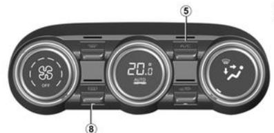
Pulse el botón **8**: el testigo integrado se enciende. Esta función permite el desempañado o el deshielo rápido de la luneta y el deshielo de los retrovisores (para los vehículos equipados con esta función).
