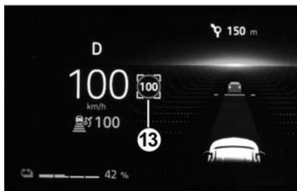
Cuando se detecta el nuevo límite de velocidad, el sistema puede proponer la velocidad detectada al conductor:
