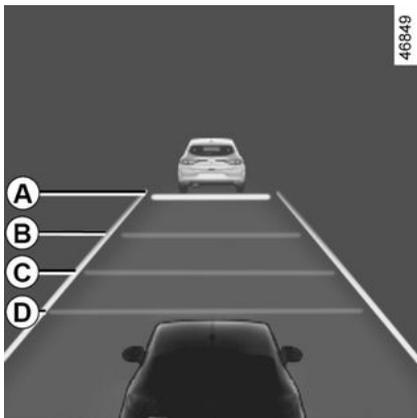
Puede cambiar la distancia de seguridad con el vehículo de delante en cualquier momento pulsando el interruptor **5** repetidamente.
