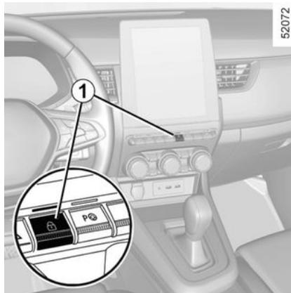
Tras arrancar el vehículo, el sistema bloquea automáticamente las puertas cuando se circula a una velocidad igual o superior a 10 km/h.
