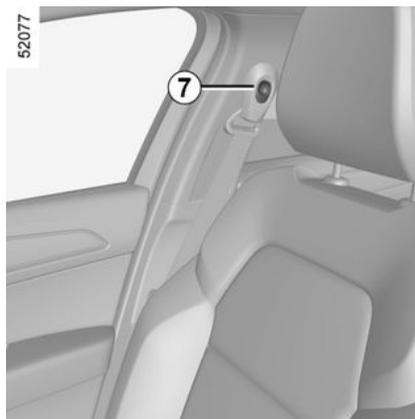
Usar el botón **7** para regular la altura del cinturón de seguridad de modo que la correa del hombro quede colocada como se ha indicado anteriormente. Presionar el botón **7** y subir o bajar el cinturón de seguridad. Una vez efectuado el reglaje, asegúrese de que queda bien bloqueado.
