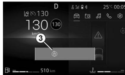
Si el vehículo se parase como consecuencia de un frenado activo de emergencia, el conductor debe mantener el vehículo parado pisando el pedal de freno.
