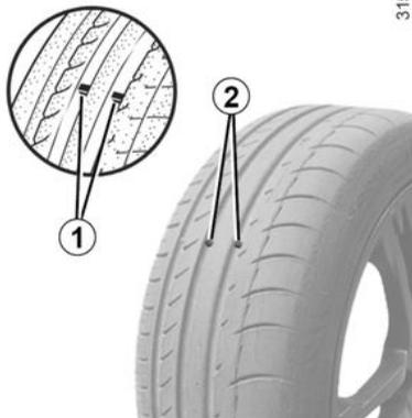
Cuando el dibujo del neumático disminuye hasta el nivel de los testigos de desgaste, **estos se hacen visibles 2: es entonces necesario sustituirlos, ya que la goma de la banda de**
