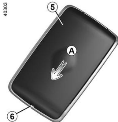
Deslizar la carcasa trasera **5** hacia abajo mientras se presiona sobre la zona **A**.
