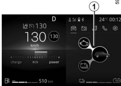
Según el modo de conducción que se haya seleccionado, el indicador 1 representa los flujos de energía entre:
