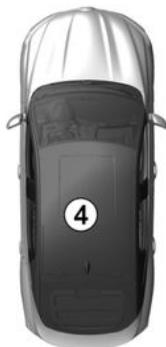
En caso de que, **con el motor en marcha**, se abra y se cierre una puerta y la tarjeta ya no se encuentre en la zona **4**, el mensaje "Tarjeta no detectada" advierte de que la tarjeta no se encuentra en el interior del vehículo. Esto permite evitar, por ejemplo, reanudar la marcha si un pasajero sale del vehículo llevándose la tarjeta.
