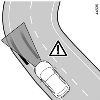
En el caso de una curva cerrada, y según la velocidad del vehículo, las capacidades de retención lateral de la función serán limitadas y requerirán que el conductor actúe de inmediato en el volante para que la función pueda seguir manteniendo el vehículo en el centro del carril.
