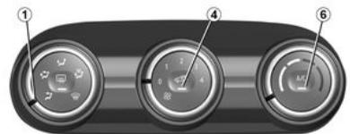
Pulse el botón **4**: el testigo integrado se enciende. En estas condiciones, el aire se toma del habitáculo y se recircula sin entrada de aire exterior.
