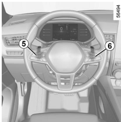
Según el vehículo, puede utilizar las palancas **5** y **6** para cambiar de marcha cuando la palanca está en posición D.
