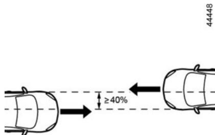
En caso de un choque frontal con otro vehículo de una categoría equivalente o superior, con una zona de choque igual o superior al 40%, donde la velocidad de ambos vehículos es igual o superior a **40 km/h**.
