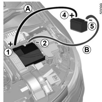
Fije el cable positivo **A** al **soporte 1** (+) situado bajo la tapa del cajetín **3** y después al **borne 4** (+) de la batería que suministre la corriente.
