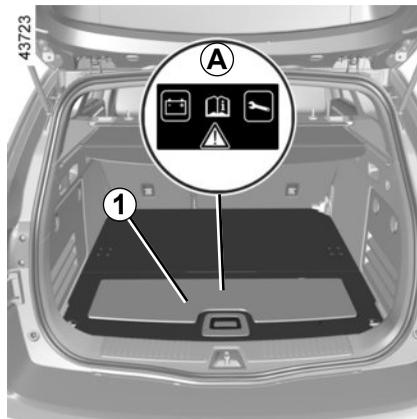
Según el vehículo, un sistema comprueba continuamente el estado de carga de la batería. Si disminuye, aparece el mensaje «Batería descargada arrancar motor» en el cuadro de instrumentos. En este caso, arranque el motor y el mensaje del cuadro de instrumentos desaparecerá.
