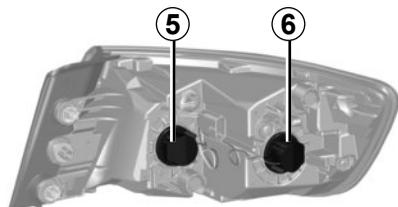
Vuelva a colocar el portalámparas y empuje el bloque de luces al máximo.
