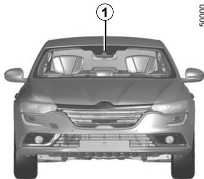
La alerta de exceso de velocidad con reconocimiento de las señales de tráfico informa al conductor de la superación del límite de velocidad en el tramo de vía en el que circula.
