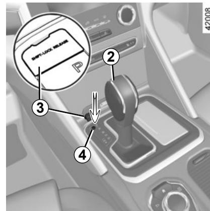
Al poner el vehículo en marcha, si la palanca se queda bloqueada en **P** aunque se pise el pedal de freno, existe la posibilidad de liberarla manualmente. Para ello, suelte la trampilla **3**, pase una herramienta (varilla rígida) por el orificio **4** y pulse simultáneamente el botón **2** para desbloquear la palanca.
