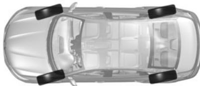
Si se circula a una velocidad superior, las ruedas traseras se orientan en el mismo sentido que las ruedas delanteras (figura **B**) con el fin de optimizar la estabilidad del vehículo. Esto resulta útil al cambiar de carril, al tomar una curva...
