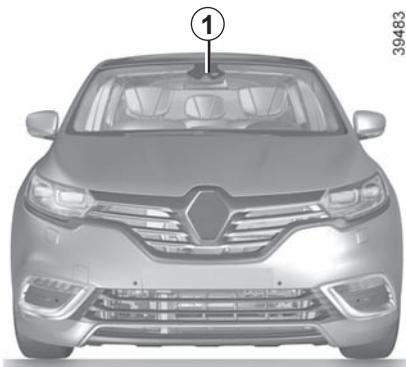
La alerta de exceso de velocidad con reconocimiento de las señales de tráfico informa al conductor de la superación del límite de velocidad en el tramo de vía en el que circula.
