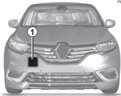
Con la ayuda del radar **1**, esta función advierte al conductor del intervalo de tiempo que lo separa del vehículo situado delante con el fin de respetar las distancias de seguridad entre los dos vehículos.
