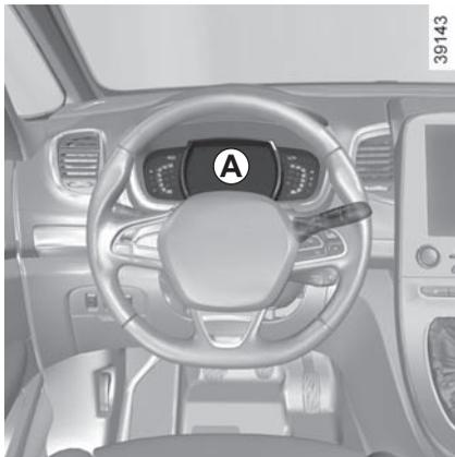
**Cuadro de instrumentos A:** se ilumina cuando se abre la puerta del conductor.
