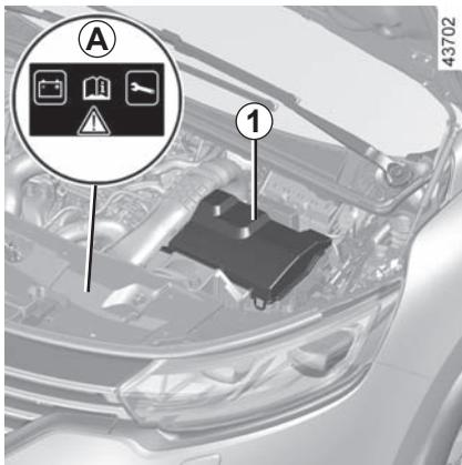
Según el vehículo, la batería **1** se encuentra en el compartimento del motor o debajo del piso del maletero.
