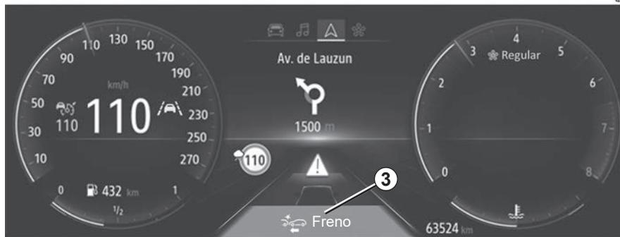
Si el vehículo se para como consecuencia de un frenado activo de emergencia, el conductor debe mantener el vehículo parado pisando el pedal de freno.
