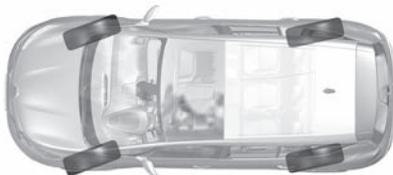
Si se circula a una velocidad superior, las ruedas traseras se orientan en el mismo sentido que las ruedas delanteras (figura **B**) con el fin de optimizar la estabilidad del vehículo. Esto resulta útil al cambiar de carril, al tomar una curva...
