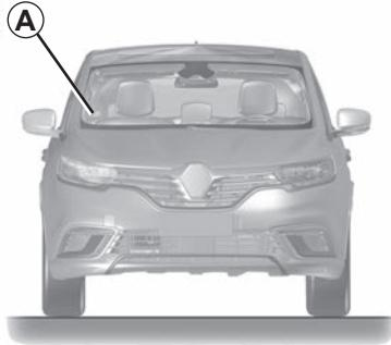
El código QR de la etiqueta **A** permite a los trabajadores de emergencia provistos de una tableta o un smartphone acceder inmediatamente a la información técnica útil para trabajar en el vehículo en caso de accidente.
