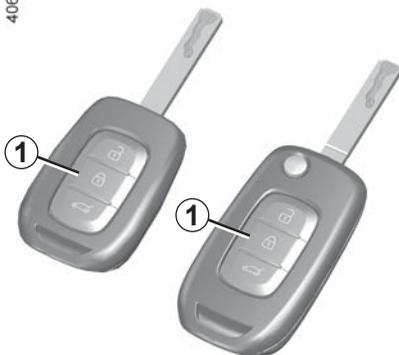
Cuando el vehículo va equipado con la supercondenación, ésta permite bloquear los abrientes e impedir así la apertura de las puertas por las empuñaduras interiores (caso, por ejemplo, de una rotura del cristal seguida de un intento de abrir las puertas por el interior).
