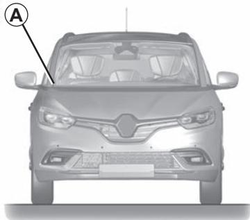
El código QR de la etiqueta **A** permite a los trabajadores de emergencia provistos de una tableta o un smartphone acceder inmediatamente a la información técnica útil para trabajar en el vehículo en caso de accidente.
