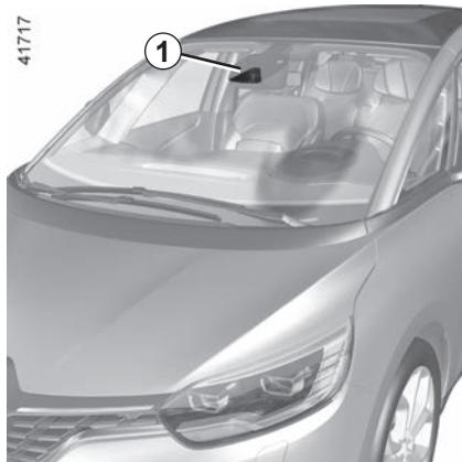
Gracias a la información de la cámara-radar **1**, la función advierte al conductor del intervalo de tiempo que le separa del vehículo que le precede, para respetar las distancias de seguridad entre los dos vehículos.
