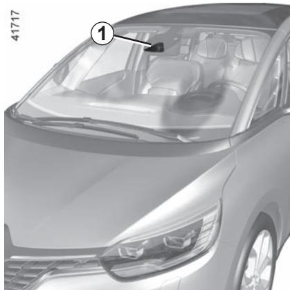
Gracias a la información de la cámara **1**, la función avisa al conductor cuando cruza una línea continua o discontinua sin activar las luces indicadoras de dirección.
