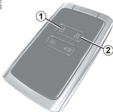
Cuando el vehículo va equipado con la supercondenación, ésta permite bloquear los abrientes e impedir así la apertura de las puertas por las empuñaduras interiores (caso, por ejemplo, de una rotura del cristal seguida de un intento de abrir las puertas desde el interior).
