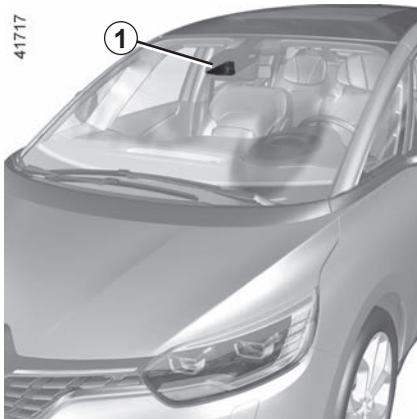
La alerta de exceso de velocidad con reconocimiento de las señales de tráfico informa al conductor de la superación del límite de velocidad en el tramo de vía en el que circula.
