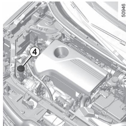
Lado derecho del vehículo: para acceder a las lámparas es necesario desmontar la boca de llenado **4** del depósito del lavacristales. Para eso:
