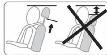
**Nota:** cuando sea necesario volver a montar el reposacabezas, preste atención a su posición que está dibujada en la etiqueta.
