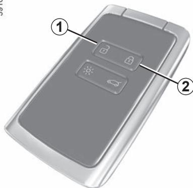
Cuando el vehículo va equipado con la supercondenación, ésta permite bloquear los abrientes e impedir así la apertura de las puertas por las empuñaduras interiores (caso, por ejemplo, de una rotura del cristal seguida de un intento de abrir las puertas por el interior).
