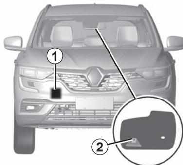
El sistema **A** está formado por el captador de radar **1** y la cámara delantera **2**.
