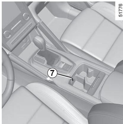
Levante el botón 7 para ventilar el portaobjetos según la temperatura ajustada por el aire acondicionado. Baje el botón para detener la función.
