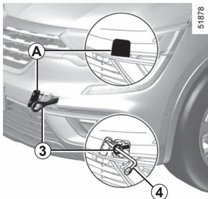
Utilice exclusivamente el punto de remolcado delantero **A** y el punto de remolcado trasero **5** (nunca utilice los tubos de transmisión).
