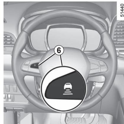
La velocidad de regulación sustituye a los guiones y se confirma la función de regulación con la iluminación en verde de la velocidad de regulación y del mensaje «ACC Regulador» además del testigo
