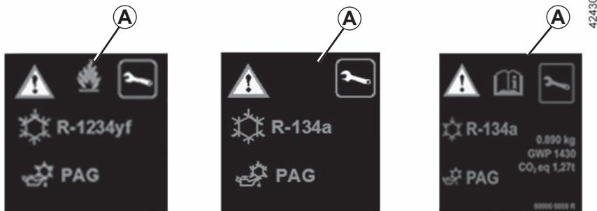
El circuito de fluido refrigerante puede contener gases fluorados de efecto invernadero.
