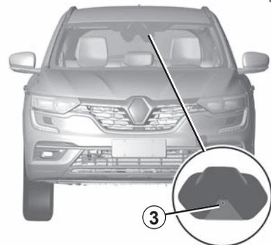
El sistema **B** utiliza el captador de la cámara-radar **3**.
