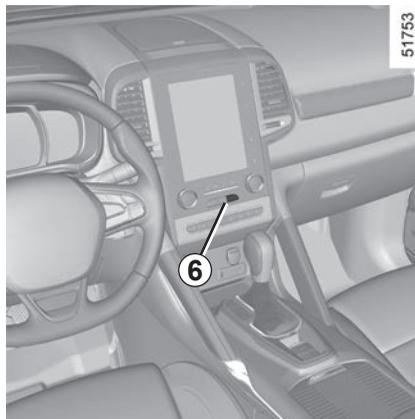
El contactor **6** acciona simultáneamente las puertas y el maletero.
