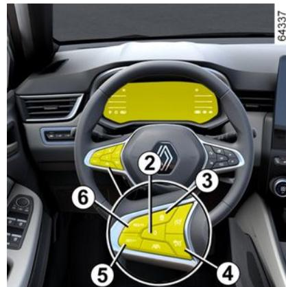
**2.** Puesta en espera de la función (con memorización de la velocidad de regulación) (0).
