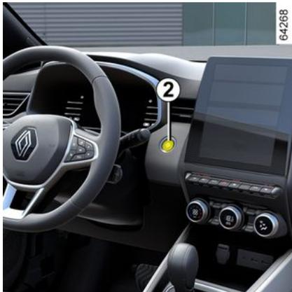
– en vehículos con caja de velocidades manual, pisar el pedal de freno y presionar el botón **2**, a continuación, soltar el pedal una vez que haya arrancado el motor.
