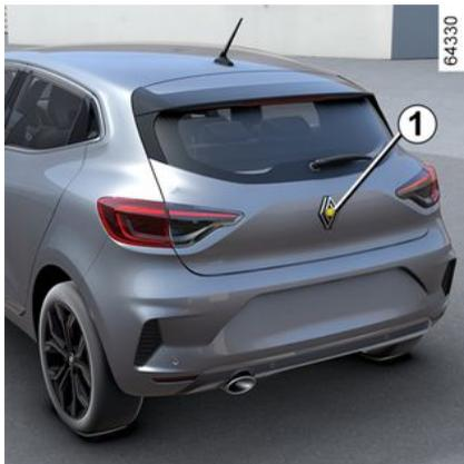
Cuando se engrana la marcha atrás, la cámara **1** situada en el portón trasero transmite una vista de la zona posterior del vehículo a la pantalla multimedia **2**, acompañada de dos líneas guía **3** y **4** (fijas y móviles).
