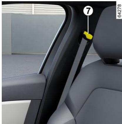
Presionar el botón **7** para regular la altura del cinturón de tal forma que la cinta del hombro quede colocada como se ha indicado anteriormente. Presionar el botón **7** y subir o bajar el cinturón de seguridad. Una vez efectuado el reglaje, asegúrese de que queda bien bloqueado.
