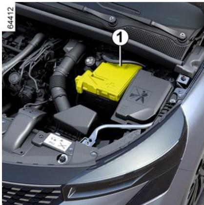
La batería **1** no requiere mantenimiento. **No debe abrirla o añadir ningún líquido.**
