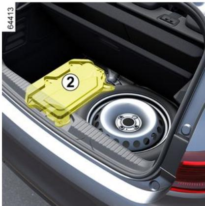
La batería secundaria de 12 V **2** está situada en el maletero del vehículo E-tech full hybrid: suministra la energía necesaria para la apertura/cierre del vehículo y el funcionamiento del equipo.
