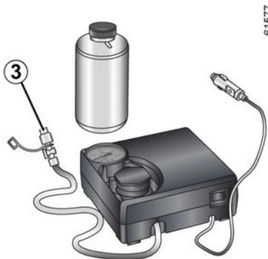
Una vez que el neumático esté correctamente inflado, extraer el kit: desenroscar lentamente el adaptador de inflado del recipiente **3** para evitar salpicaduras del producto y, a continuación, guardarlo en un embalaje de plástico para prevenir que gotee.
