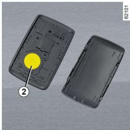
Para volver a colocar la tapa, después proceda en orden inverso y, a continuación, presione cuatro veces uno de los botones de la tarjeta permaneciendo cerca del vehículo: la próxima vez que arranque el vehículo, desaparecerá el mensaje. Compruebe que la tapa esté bien encajada.
