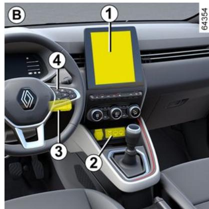
Puede utilizar los puertos USB para acceder al contenido multimedia de los dispositivos que conecte y para la actualización del sistema.
