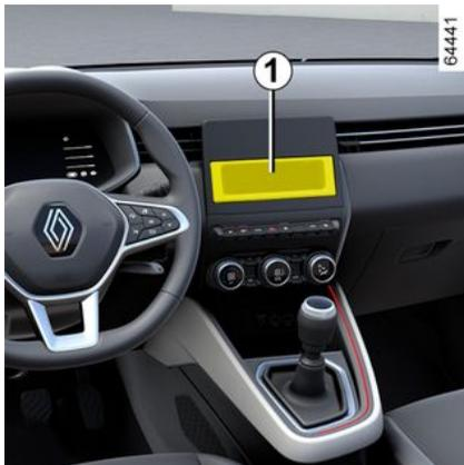
Suelte la cubierta. Las conexiones (antena, + y alimentación de -, cableado de los altavoces) se encuentran detrás.
