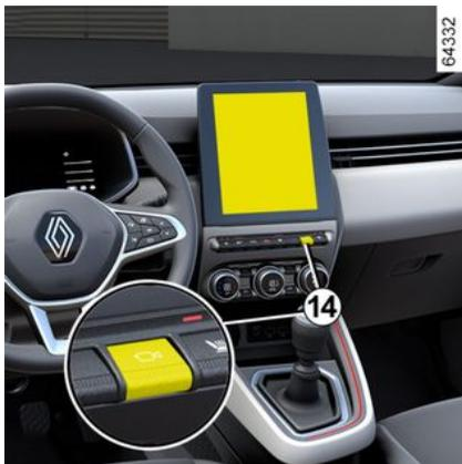
Con el encendido conectado, presionar el interruptor **14** o desplazar la palanca selectora a la posición P (en vehículos con caja de velocidades automática) o a la posición de marcha atrás (en vehículos con caja de velocidades manual) para poder utilizar la función.
