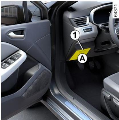
Si un componente eléctrico no funciona, verifique el estado de los fusibles.
