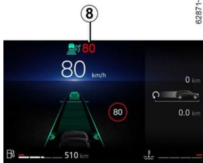
Se puede exceder la velocidad de regulación en cualquier momento pisando el pedal del acelerador.
