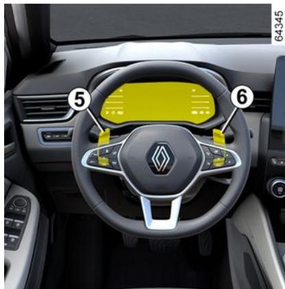
En función del vehículo, las levas del cambio de marchas 5 y 6 pueden utilizarse para cambiar velocidades cuando la palanca se encuentra en la posición D.
