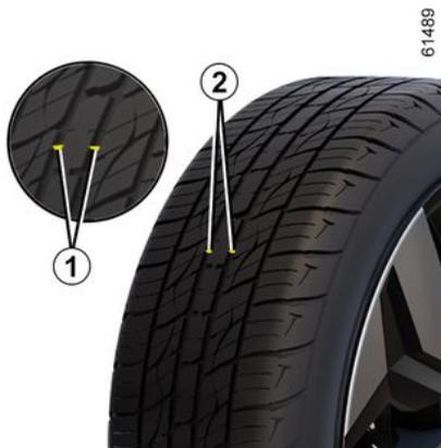
Los neumáticos deben estar en buen estado y las bandas de rodadura han de tener una profundidad suficiente: los neumáticos homóloga-
