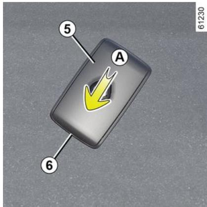
Deslizar la carcasa trasera **5** hacia abajo mientras se presiona la zona **A**.
