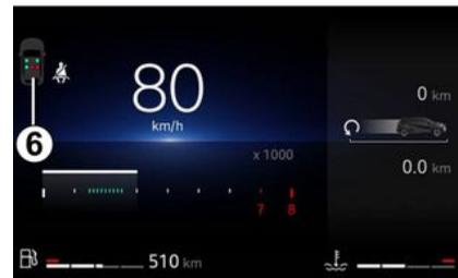
Con las puertas cerradas, el gráfico **6** aparece en el panel de instrumentos durante aproximadamente 60 segundos al poner contacto. De este modo se informa al conductor del estado de cada uno de los cinturones de seguridad delanteros cada vez:
