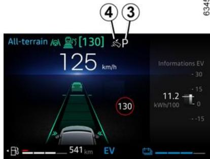
La pantalla **3** situada en el cuadro de instrumentos le informa de la posición de la palanca de velocidades seleccionada **1**.
