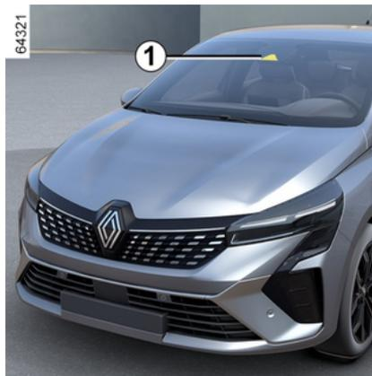
A partir de la información procedente de la cámara 1, la función ejecuta acciones correctivas en el sistema de dirección del vehículo cuando se rebasa una línea continua o discontinua o cuando se aproxima al borde de la carretera (divisoria, bionda, acera, terraplén, etc.) sin activar las luces indicadoras de dirección.
