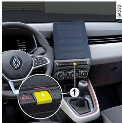
Tras arrancar el vehículo, el sistema bloquea automáticamente las puertas una vez alcanzada la velocidad aproximada de 10 km/h.
