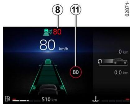
Según el vehículo, con la función "Detección de señales de tráfico" activada, presionar el interruptor **5** (SET/-) o **6** (RES/+) para adaptar la velocidad **11** a los límites de velocidad que detecte la cámara.
