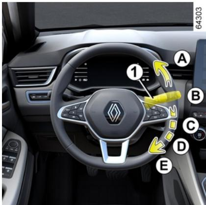
Para volver a colocar los limpiaparabrisas, póngalos primero en la posición de reparación **B**.
