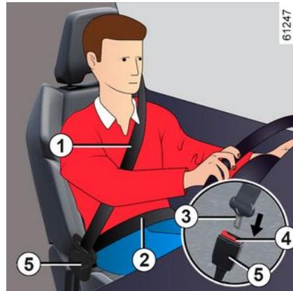
Para garantizar el ajuste y la colocación correctos de los cinturones de seguridad en todos los asientos:
