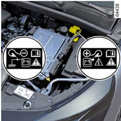
Conecte el cable positivo **C** al borne **6 (+)** y, seguidamente, al borne **10 (+)** de la batería que suministra la corriente.
