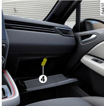
Soltar la luz **4** presionando la pestaña hacia su izquierda (con un destornillador de punta plana o similar).
