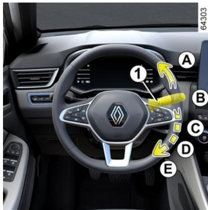
Esta posición permite levantar las escobillas para separarlas del parabrisas.
