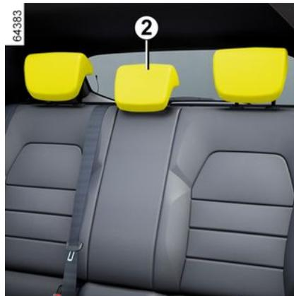
Introduzca las varillas en sus alojamientos; presione el reposacabezas hasta que quede bloqueado para utilizarlo en posición alta.
