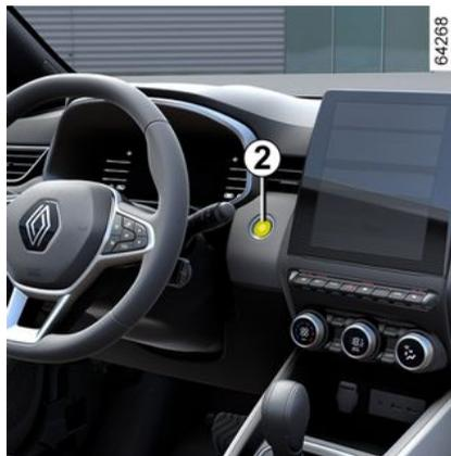
Si el smartphone ya no está en el compartimento cuando se intenta apagar el motor, aparece el siguiente mensaje en el cuadro de instrumentos: mantener presionado el botón de arranque/parada del motor **2** durante más de dos segundos.
