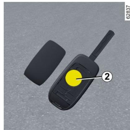
**Nota:** al sustituir la pila, se aconseja no tocar el circuito electrónico situado en la tapa de la llave.
