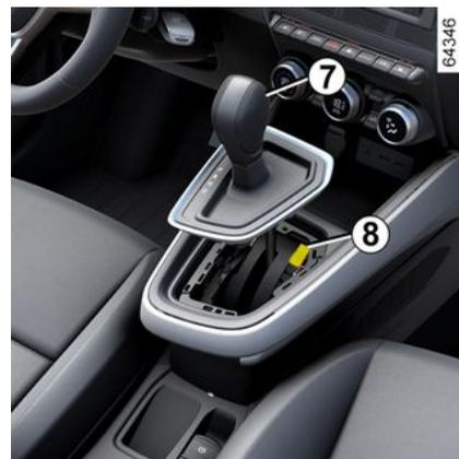
**Al arrancar**, si la palanca se queda bloqueada en P al presionar el pedal de freno (p. ej.: avería de la batería), es posible soltar manualmente la
