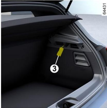
Soltar la luz **3** presionando la pestaña hacia su izquierda (con un destornillador de punta plana o similar).
