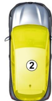
**Con el motor en marcha**, si se abre y cierra una puerta y la tarjeta ya no se encuentra en la zona **2**, el mensaje "Tarjeta no detectada" le avisa de que la tarjeta ya no se encuentra en el vehículo. Esto permite evitar, por ejemplo, reanudar la marcha si un pasajero sale del vehículo llevándose la tarjeta.
