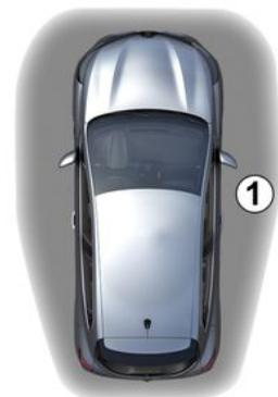
Con la tarjeta en la zona de acceso **1**, se desbloquea el vehículo. El desbloqueo se visualiza mediante **un encendido** de las luces de emergencia y de las luces indicadoras de dirección.
