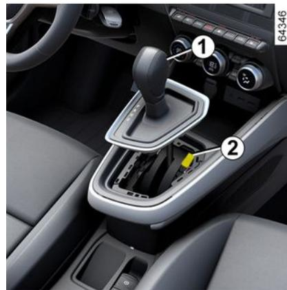
Al iniciar la marcha, si la palanca se queda bloqueada en la posición P aunque se pise el pedal de freno, existe la posibilidad de liberarla manualmente para desbloquear las ruedas motrices.
