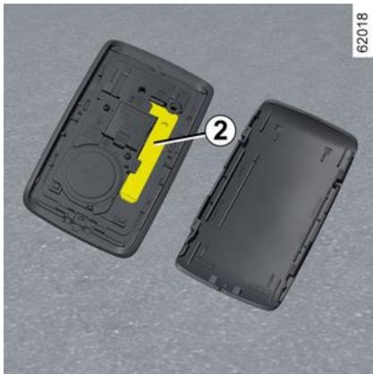
La llave integrada **2** se puede utilizar para bloquear o desbloquear la puerta del conductor cuando la tarjeta no funciona.
