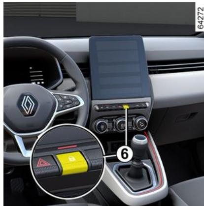
El botón **6** controla las puertas, la puerta del maletero y la tapa del depósito de carburante de forma simultánea.
