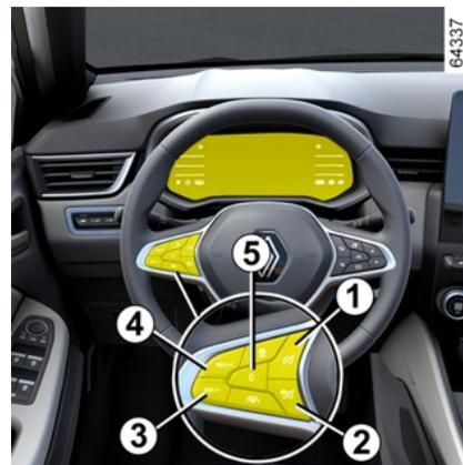
La función limitador de velocidad quedará en stand-by cuando usted pulse el contactor **5** (O).
