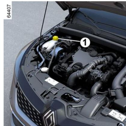
Con el motor apagado y el vehículo sobre una superficie plana, el nivel **cuando hace frío** debe situarse entre las marcas "MINI" y "MAXI" del depósito de refrigerante **1**.
