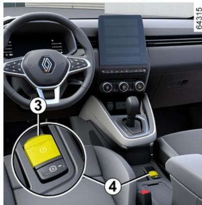
Para activar el freno de aparcamiento asistido de forma manual (en caso de parada en un semáforo en rojo, parada con el motor en marcha, etc.): tirar del interruptor **4** y soltarlo.
