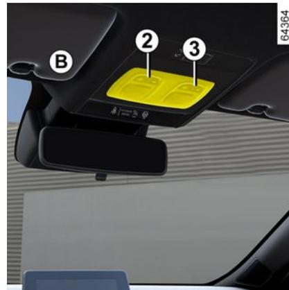
Pulse el interruptor **2** en el caso del conductor y el **3** en el del acompañante para activar:
