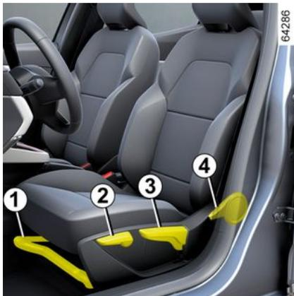
Levante y sujete la empuñadura **1** para desbloquear el asiento.
