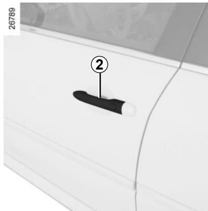
Después de desbloquear el vehículo o el maletero solamente mediante el botón de la tarjeta RENAULT, el bloqueo por alejamiento y el desbloqueo «manos libres» se desactivan.
