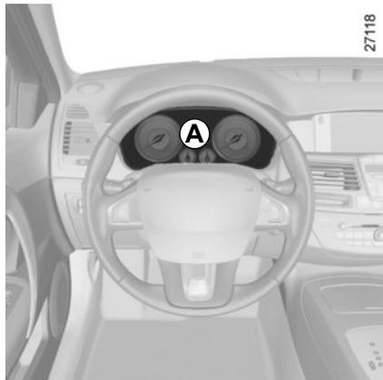
**Cuadro de instrumentos A:** se ilumina al poner el contacto. El encendido de ciertos testigos está acompañado por un mensaje.
