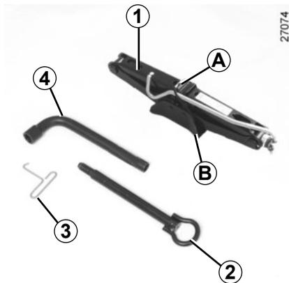
El bloque de herramientas está situado en el maletero: levante la moqueta del maletero, retire el gato y después afloje la fijación central. Cuando lo vuelva a colocar, encaje el gato con la base **B** hacia abajo imperativamente.
