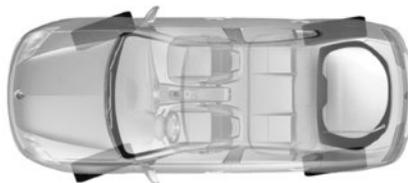
Si se circula a velocidad superior a 60 km/h, las ruedas traseras se orientan en el mismo sentido que las ruedas delanteras (figura **B**) con el fin de optimizar la estabilidad del vehículo. Esto resulta útil al cambiar de carril, al tomar una curva...
