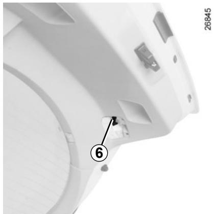
Afloje el tornillo 6 para poder retirar el bloque de luces 7 empujándolo hacia el exterior.
