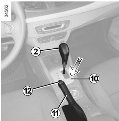
**Durante la puesta en marcha,** si la palanca se queda bloqueada en **P** si se pisa a la vez el pedal de freno y el botón de desbloqueo **2**, hay la posibilidad de liberar manualmente la palanca. Para ello, presione el botón pasando un objeto por el orificio **10** y presione simultáneamente el botón de desbloqueo **2** situado en la palanca.
