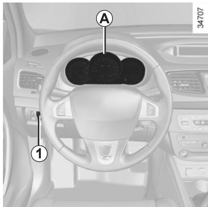
**Cuadro de instrumentos A:** se ilumina al poner el contacto. Se puede regular la intensidad luminosa girando la moleta **1**.
