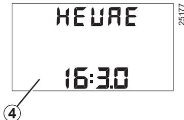
Termine con una presión prolongada en el botón 6 para validar el ajuste de las horas.
