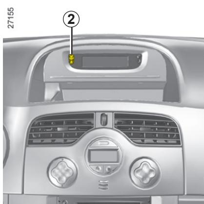
Con el contacto puesto, verifique imperativamente que el testigo **2**
