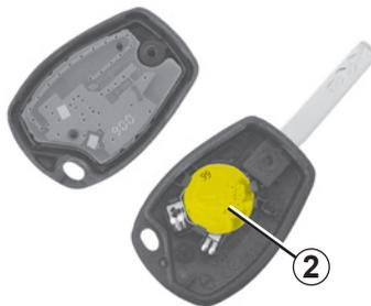
**Nota:** al sustituir la pila, tenga cuidado de no tocar el circuito electrónico situado en la tapa de la llave.
