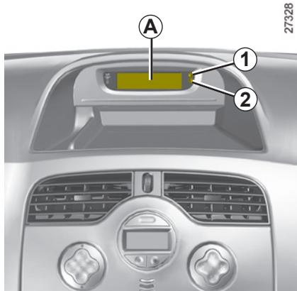
Con el contacto puesto, se visualizan la hora y la temperatura exterior.
