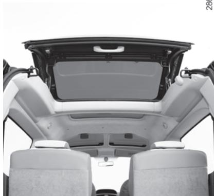
**Nota:** al circular con el techo abierto, se pueden escuchar ruidos de aire. Para reducirlos, abra completamente los techos solares con mandos manuales (consulte el párrafo: «Techo solar manual» en el capítulo 3).
