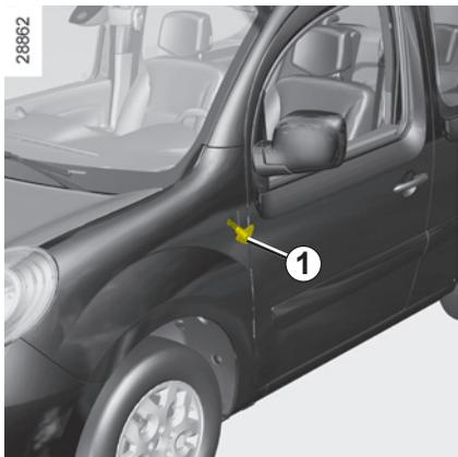
Suelte el repetidor **1** por el lado de la puerta, utilizando, por ejemplo, un destornillador plano.
