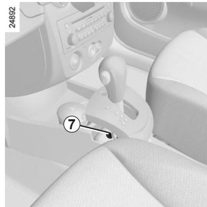
**Al poner el vehículo en marcha**, si la palanca se queda bloqueada en **P** al pisar el pedal de freno, existe la posibilidad de liberarla manualmente. Para ello, suelte la base de la palanca, pulse simultáneamente en la marca **7** visible en el fuelle y en el botón de desbloqueo situado en la palanca.
