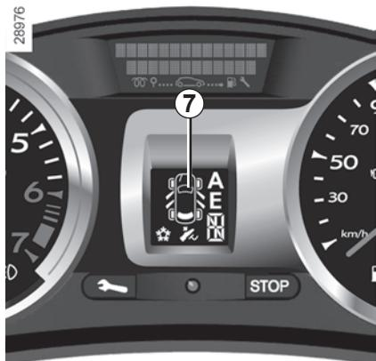
**Testigo de abriente o pantalla multifunción 7 (según el vehículo)**
