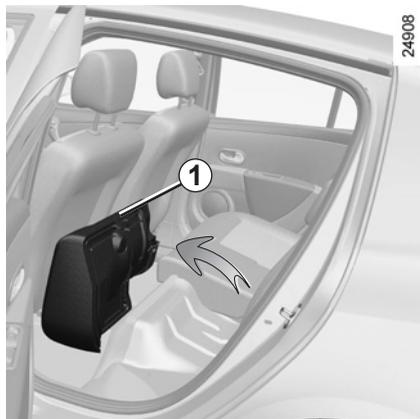
A continuación, levante la parte trasera **1** del cojín y después haga pivotar el asiento hasta colocarlo contra los asientos delanteros.
