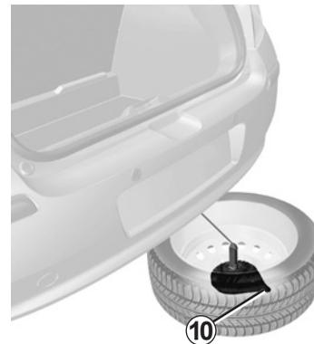
Colóquese detrás del vehículo y tire de la empuñadura **6** para levantar la rueda hasta que quede sujeta debajo del vehículo.
