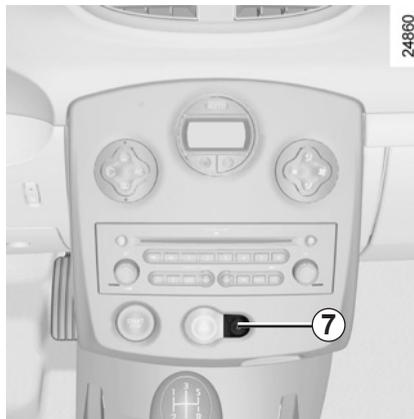
Para cerrar el vehículo con un abriente abierto (transporte de objetos en el maletero abierto...), o cuando se encuentra situado en una zona sometida a una fuerte radiación electromagnética, o en caso de fallo de la llave o la tarjeta RENAULT: con el contacto cortado, pulse durante más de cinco segundos el contactor 7.
