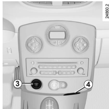
**Nota:** si cualquier otra relación distinta del neutro se visualiza, ésta parpadea, el arranque no será posible hasta que no pise el pedal de freno, con la tarjeta RENAULT en la zona de detección **1** o en el lector de tarjeta **4**.
