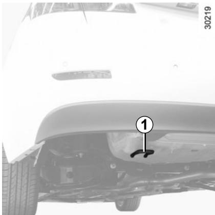
Utilice exclusivamente el punto de remolcado trasero **1** y el punto de remolcado delantero **4** (nunca los árboles de transmisión). Estos puntos de remolcado sólo pueden ser utilizados para el remolcado. En ningún caso deben servir para levantar directa o indirectamente el vehículo.
