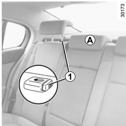
Existen apoyacabezas ajustables en la banqueta trasera según el modelo del vehículo.
