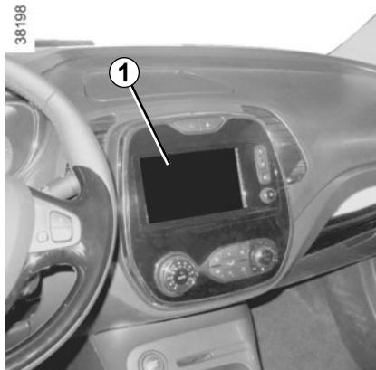
**Nota:** según el vehículo, la pantalla **1** permite visualizar el entorno del vehículo como complemento de las señales acústicas.
