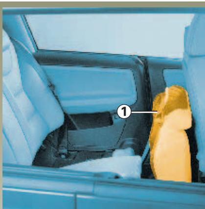
Para permitir el transporte de objetos voluminosos la banqueta y el respaldo se pueden abatir (en una o en dos partes).
